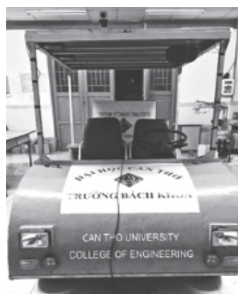
Hình 1. Mô hình xe điện được bố trí webcam để thu hình ảnh
